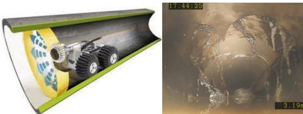
Figura 24 - Esempio di videoispezione per potenziali necessità di risanamento
