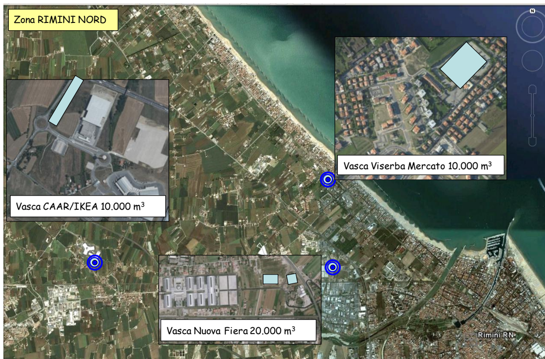
Figura 5.4. Ubicazione delle vasche presenti allo stato attuale nella zona di Rimini Nord
