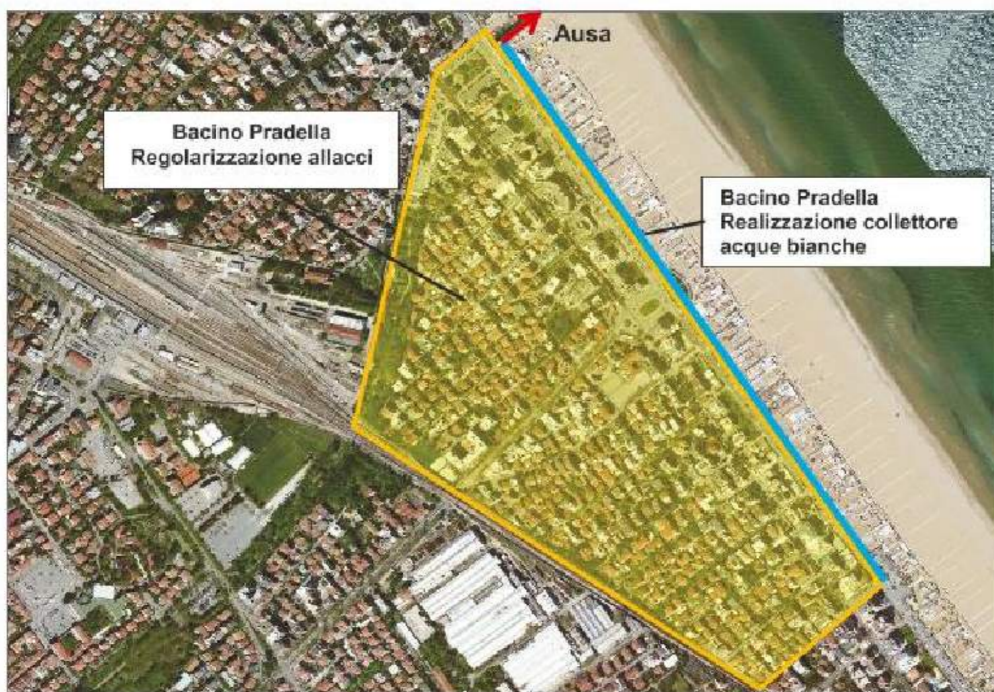
Figura 9.10. Interventi di sistemazione nel bacino del Pradella
