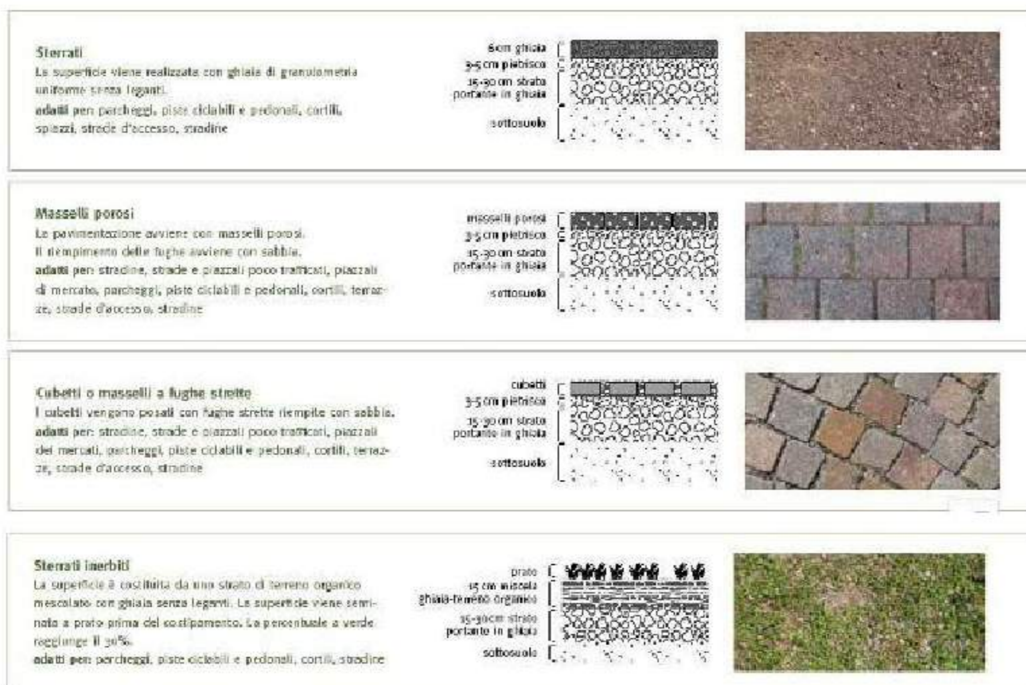
Figura 3.31 – Tipologie pavimentazioni porose [http://www.provinz.bz.it]
