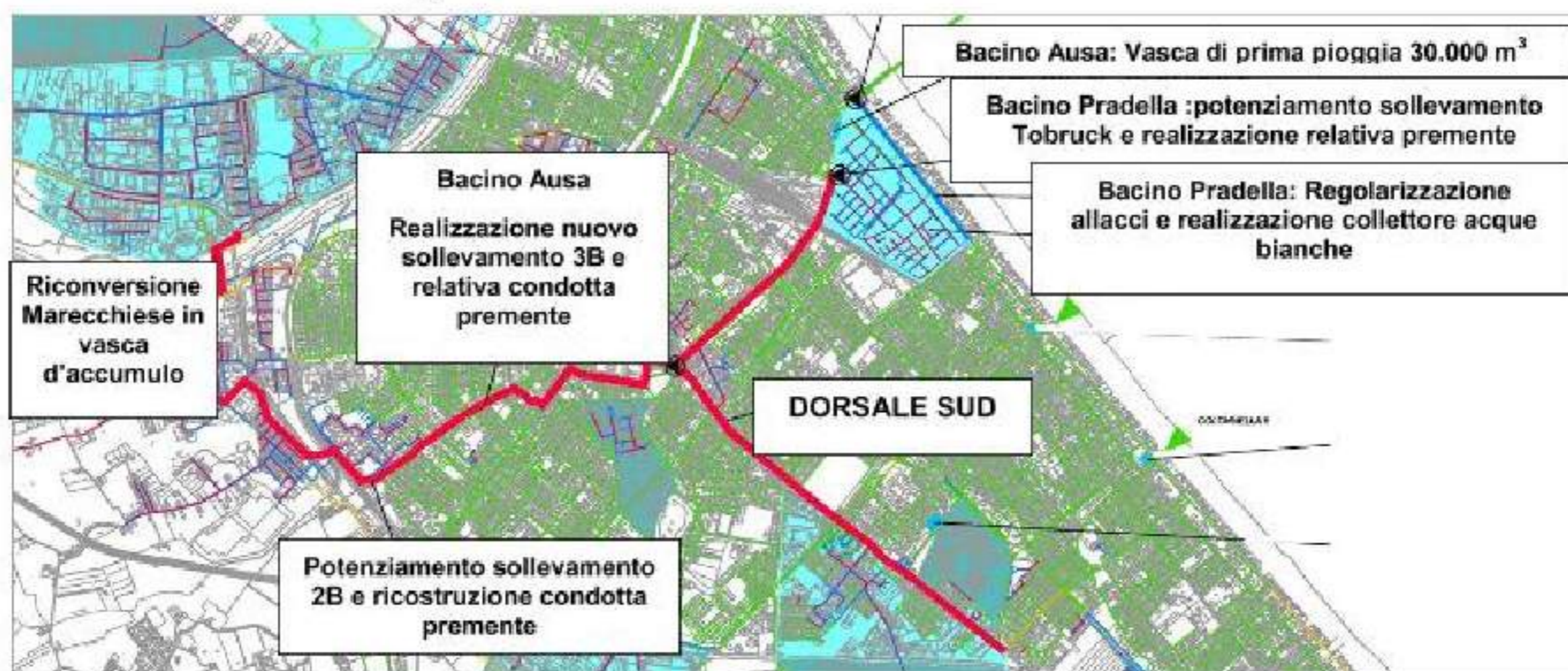
Figura 9.7. Schema della realizzazione della dorsale Sud
