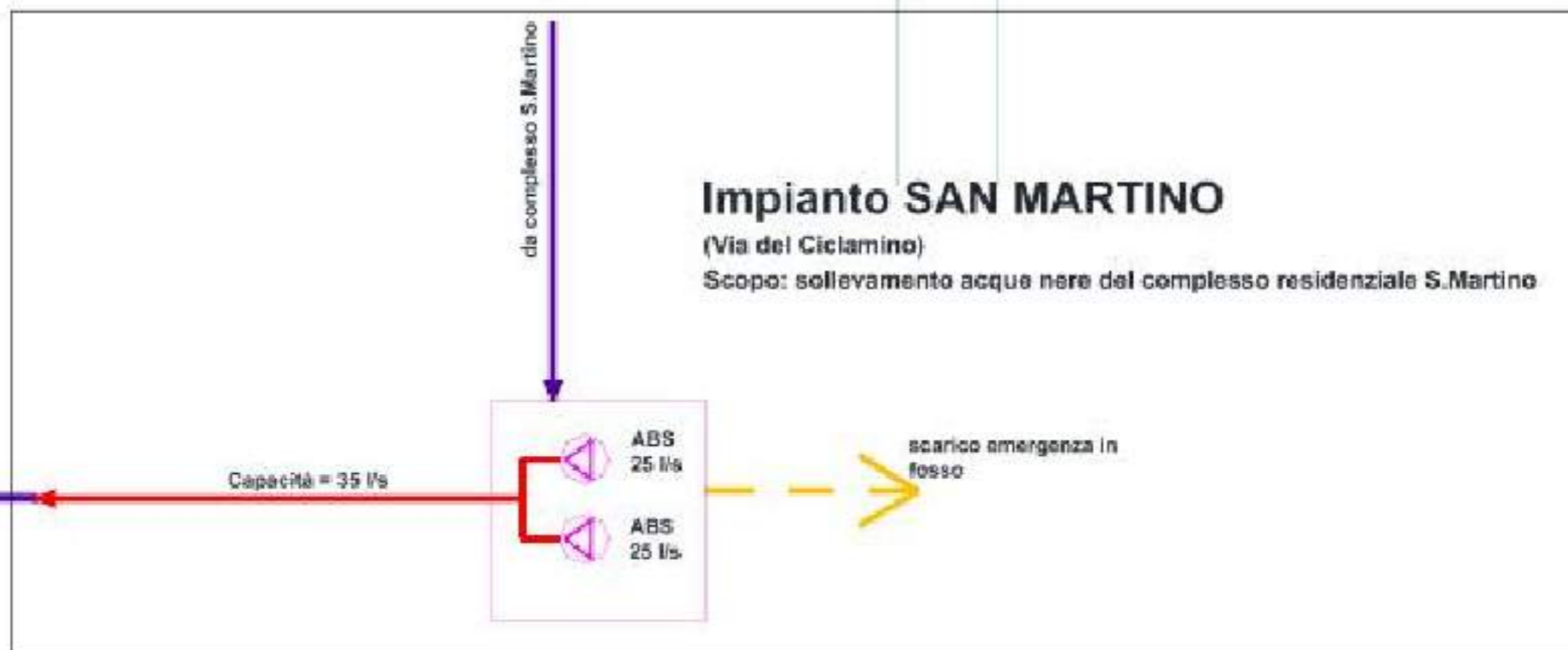
Figura 5.46. Schema planimetrico dell'impianto San Martino
