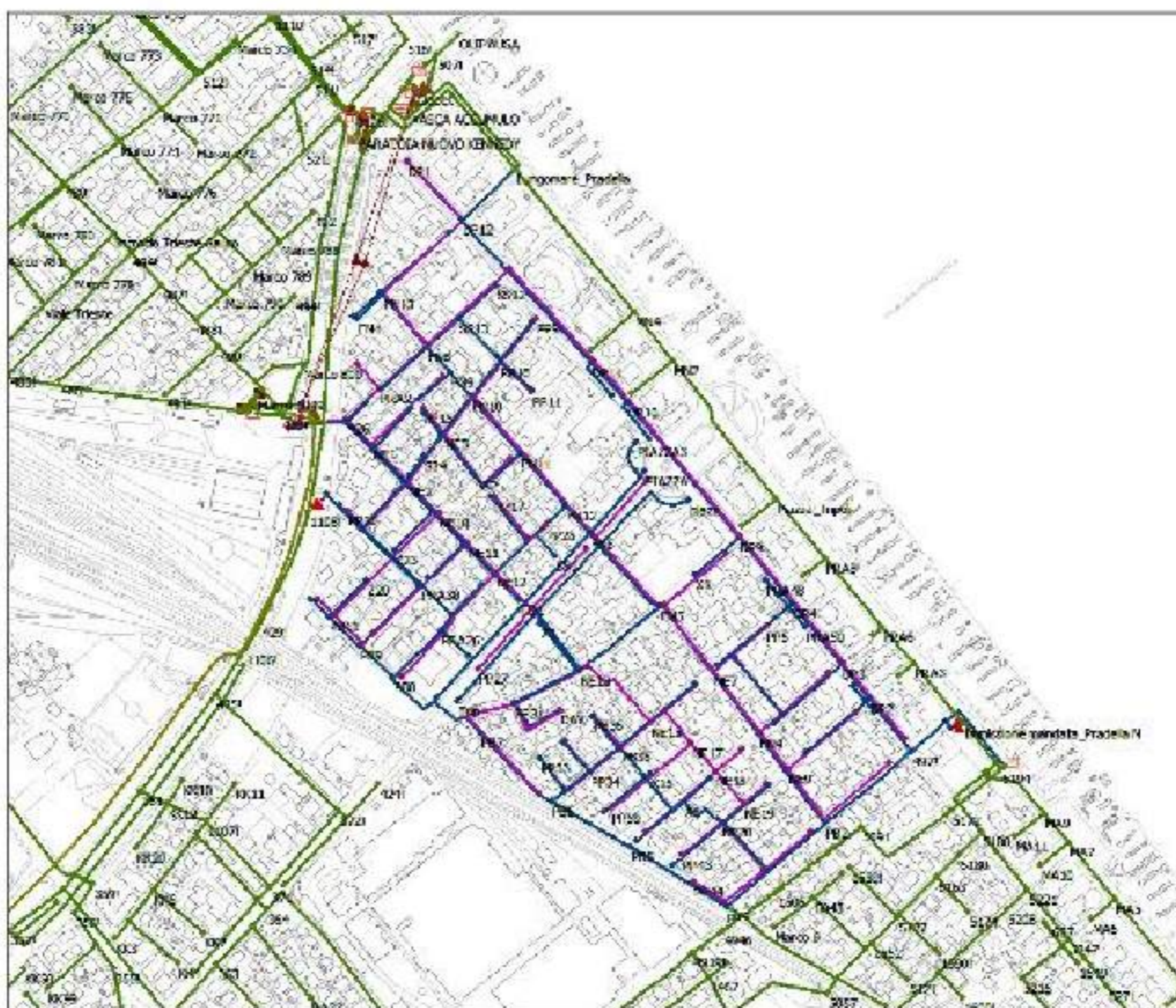
Figura 5.29. Modello della rete della zona dell'ex fossa Pradella. Le condotte verdi sono quelle di rete mista, quelle blu e viola di rete separata.
