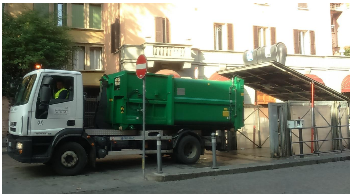
Figura 2.9: Movimentazione del cassone bivano. Isola interrata di Piazza Aldrovandi (Stralcio 1)
