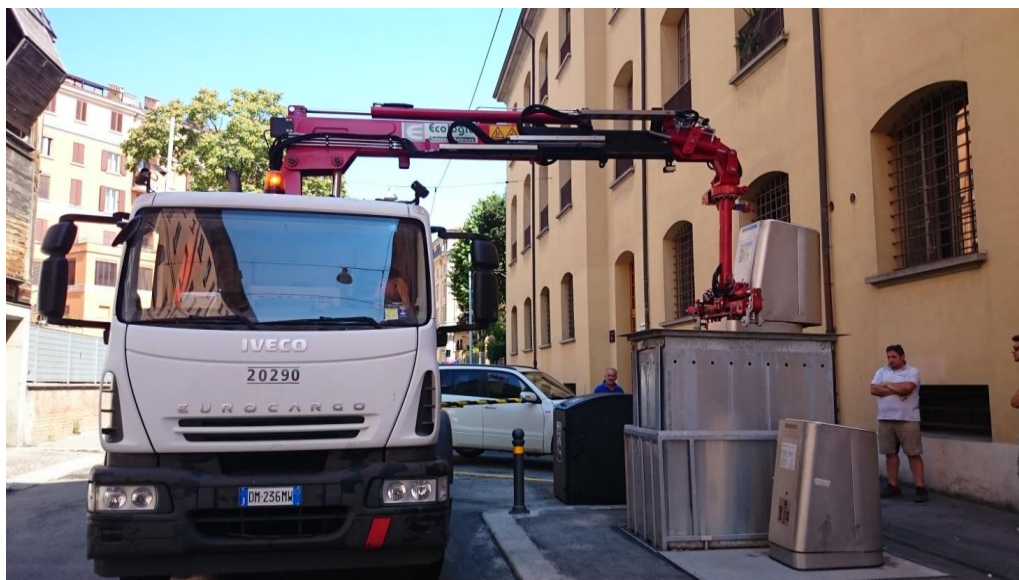
Figura 2.5: braccio robotizzato per l'estrazione e la movimentazione dei contenitori
