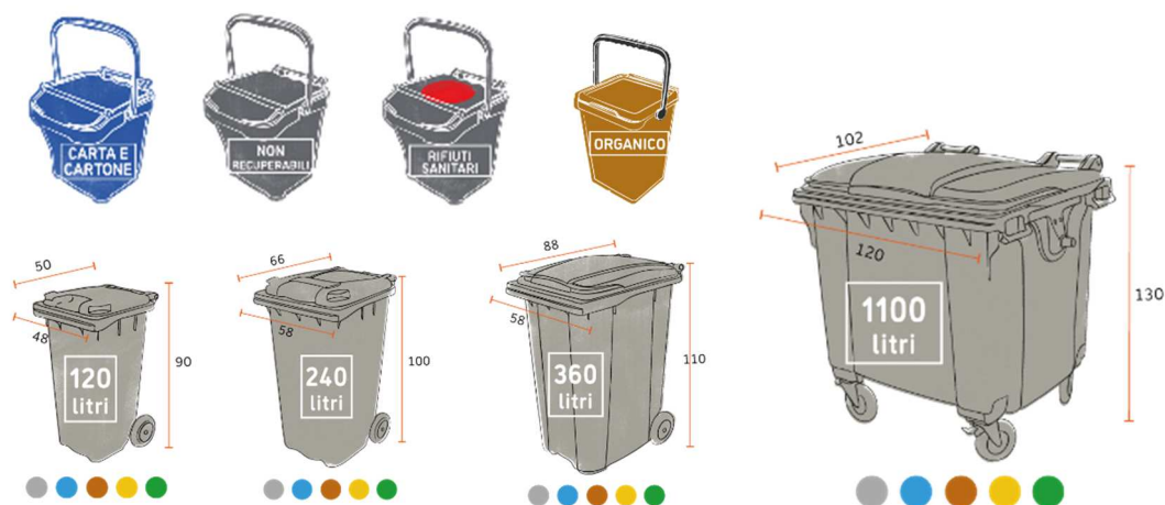
Figura 1: esempio di volumetria e dimensione (cm) dei contenitori adibiti alla raccolta dei rifiuti con modalità "porta a porta".
